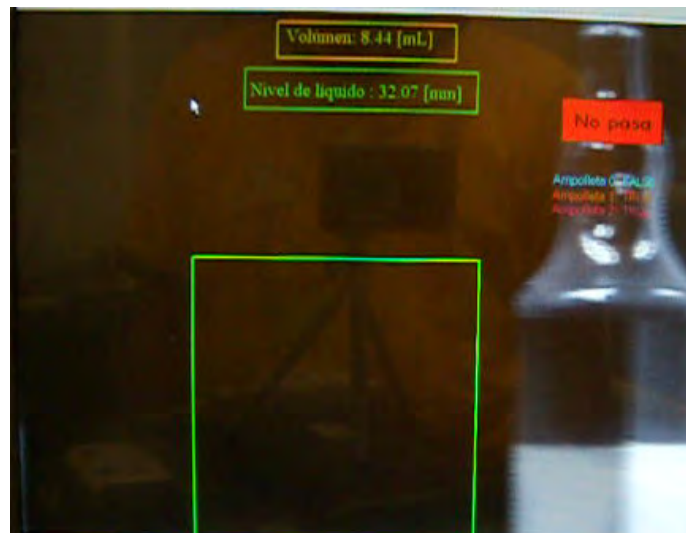
Figura 5.14. Resultado de la validación de la ampolleta 1 de la Prueba C.
