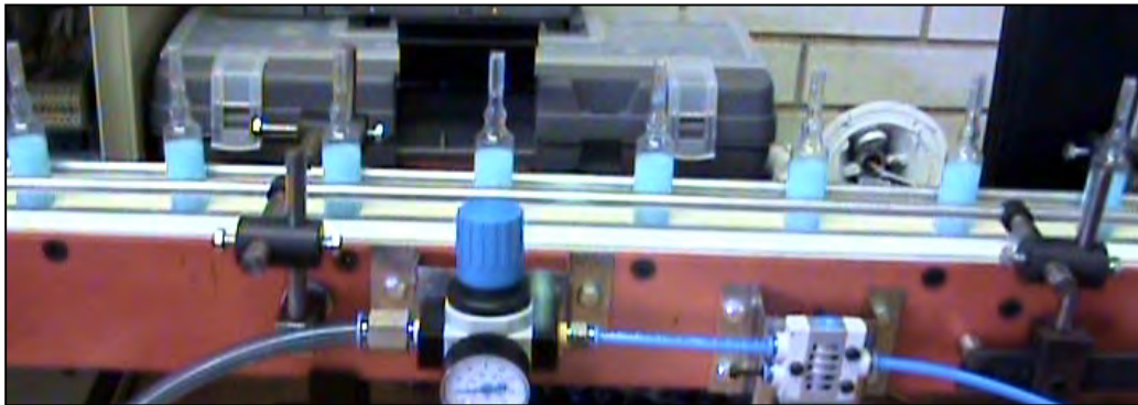
Figura 5.6. Distribución de las ampollas en el transportador.
