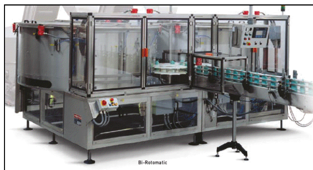
Figura I. Máquina posicionadora de botellas Bi-Rotomatic.
