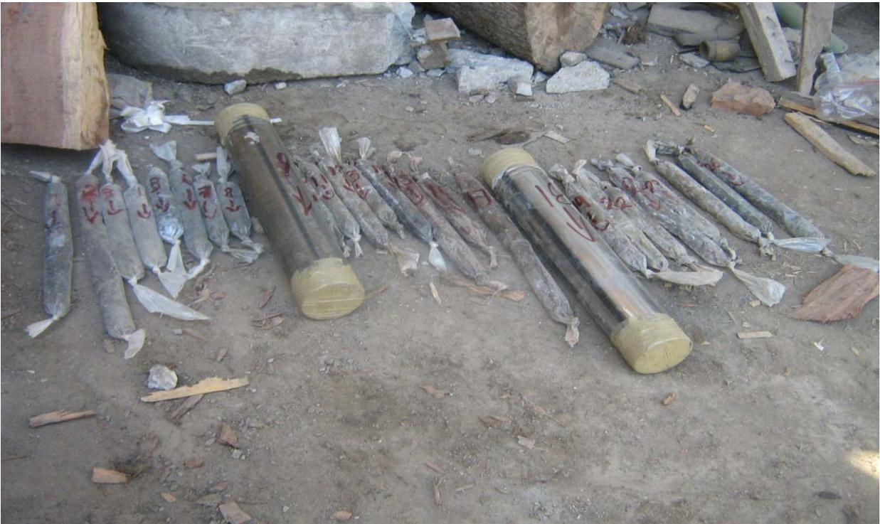
FOTO 14 Parte de la muestras recolectadas durante los trabajos de exploración del sondeo mixto 2, SM -2.
