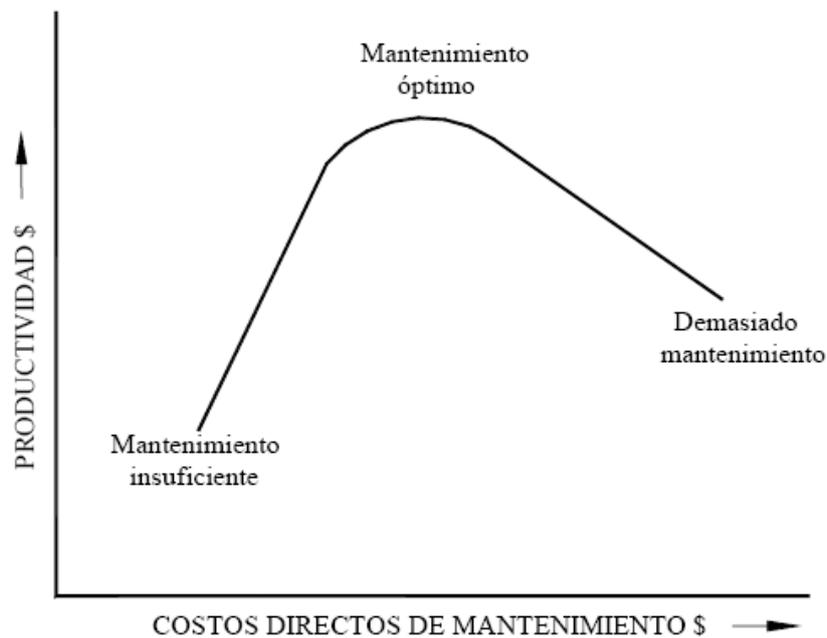
Fig. 2.2 Gráfica de costo-productividad para equipo eléctrico en función del mantenimiento aplicado.
