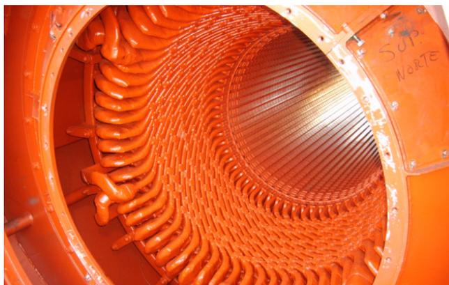
Figura 24a. Enbobinado del generador
