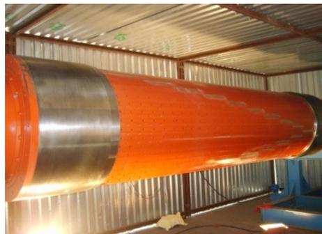
Rotor de un generador
