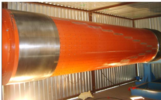
Figura 39b. Rotor del generador en pruebas
