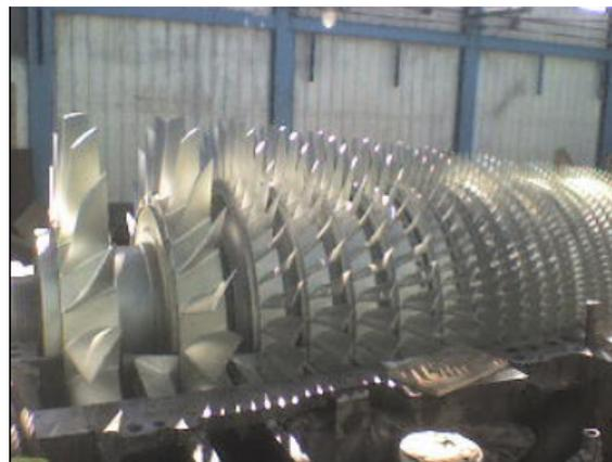
Figura 2. Compresor axial
