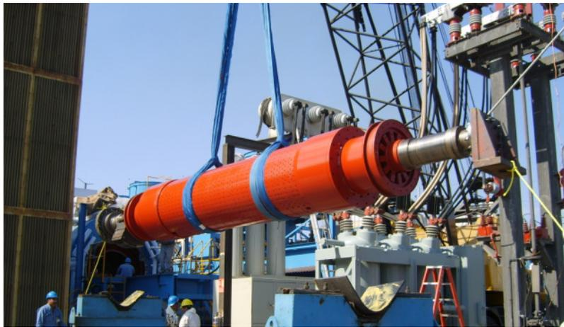
Figura 39 a. Rotor de generador eléctrico
