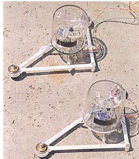
Figura 1.1 b) Fotografía de dos inclinómetros compactos de silicio instalados en campo.
