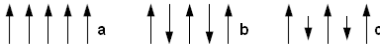
Figura 1.5 Representación esquemática de los espines atómicos en las estructuras ordenadas de espín (a) ferromagnéticas Ej. Hierro (b) antiferromagnéticas Ej. Hematita (c) ferromagnéticas Ej. Magnetita (modificado de Reitz, 1972)
