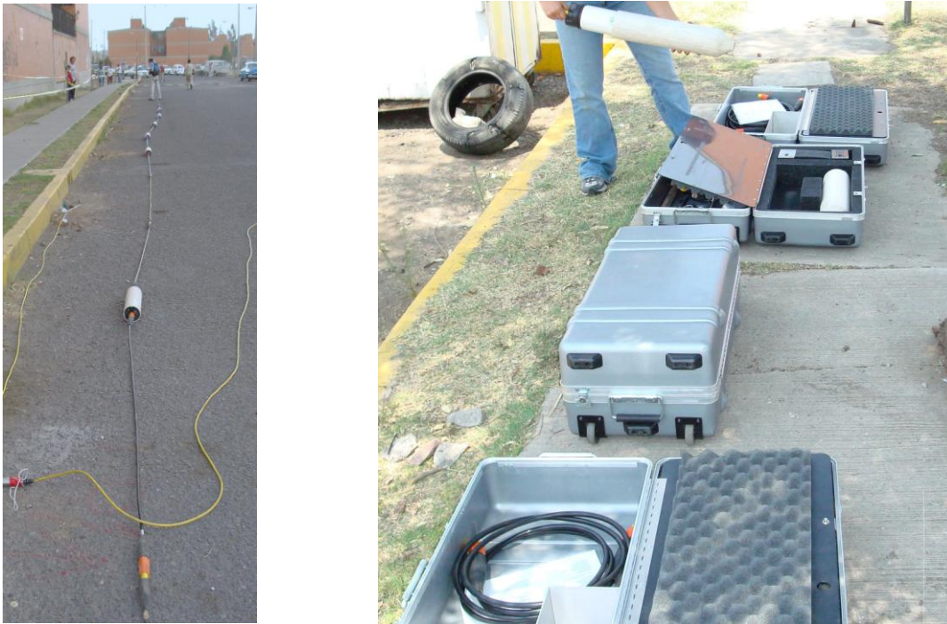
Figura 18. OhmMapper modalidad TR5, del lado derecho armado de los componentes y a la izquierda funcionamiento del equipo a lo largo del pavimento.
