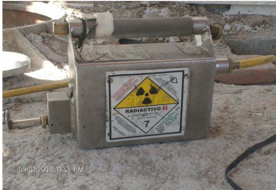
Fig. II.2 Equipo para la toma de radiografías a soldaduras.
