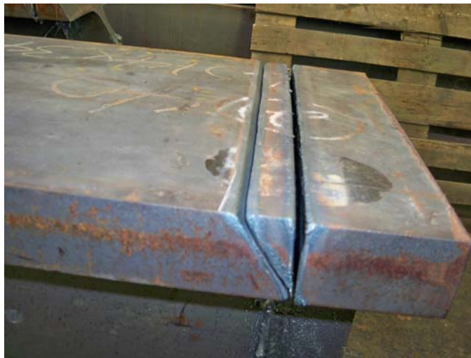
Fig. IV. 6 Típica preparación de borde para la aplicación de soldadura.
