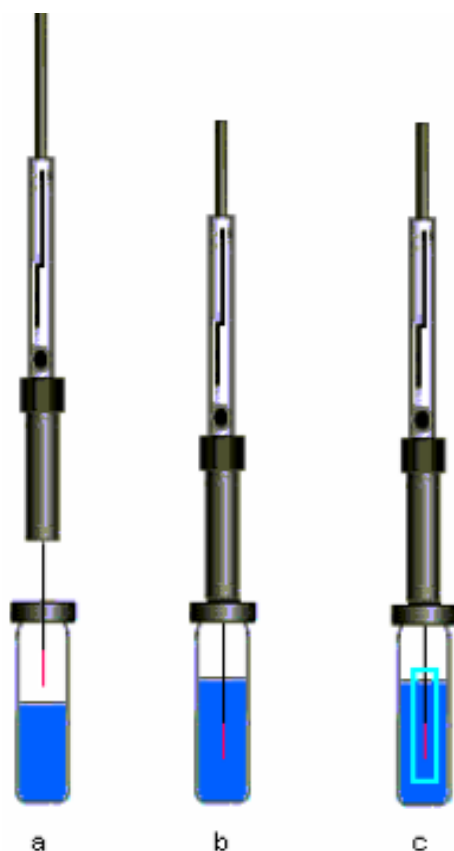
Figura 3. Posiciones de la fibra para MEFS: a) headspace, b) inmersión, c) protección con membrana
