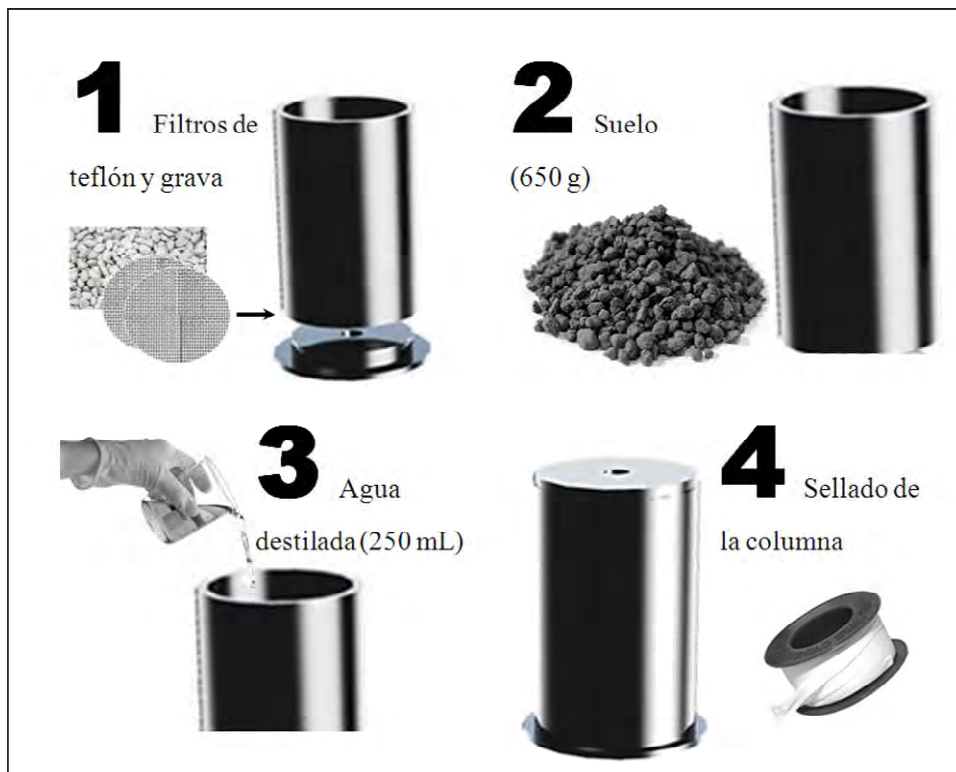
Figura 4-2 Empacado de las columnas
