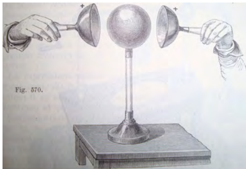
Aparato de esferas de varios diámetros Ganot—anexo 8
