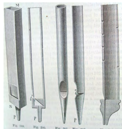
Tubos de émbolo para medir la onda sonora Ganot—anexo 8
