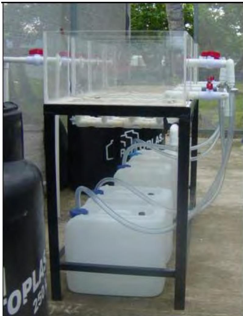
*Figura 26. Propuesta de Humedal Artificial "HAFLS" a escala laboratorio*
