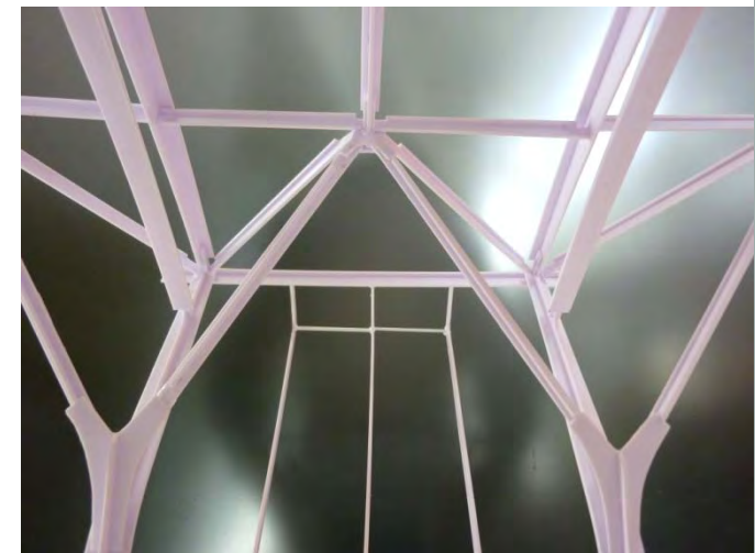
Vista frontal de dos columnas cm-1, y la unión de sus brazos
