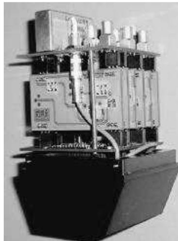
Figura 3.6. Módulo detector del escáner PET del Albira ARS.
