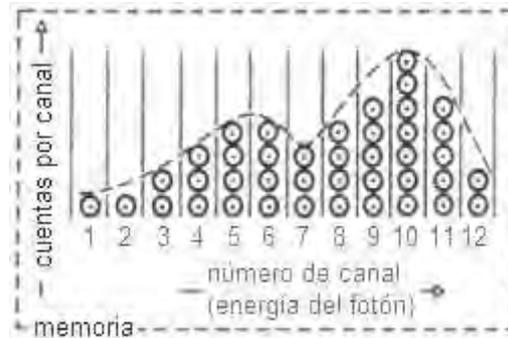
Figura AII.4. Conteo de un analizador multicanal [662].
