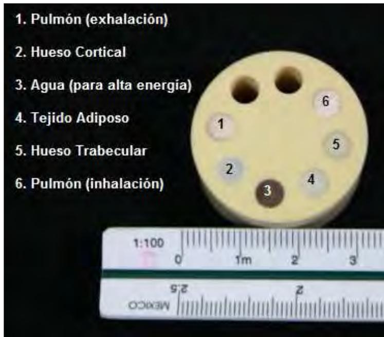
Figura 4.23. Maniquí de unidades Hounsfield diseñado y construido por el grupo del SiBi.
