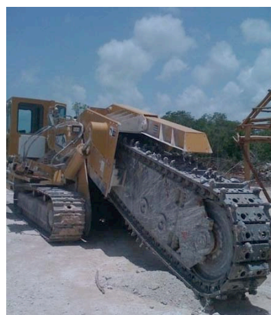
Fig. 1 Zanja para abastecimiento de agua potable Fig. 1.a Zanjadora utilizada en el proyecto
