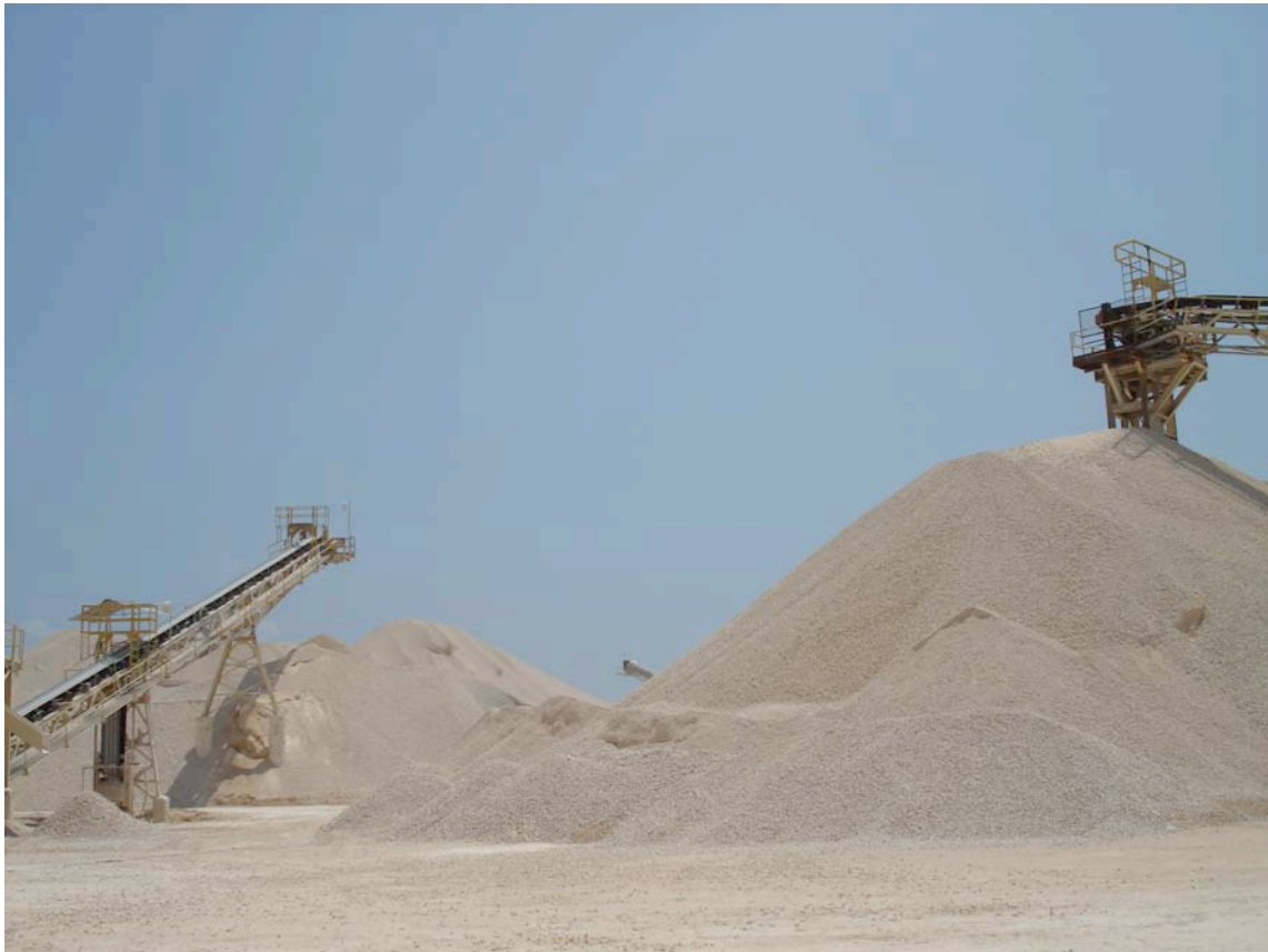
Transporte y apilamiento de material por tamaño de agregado
