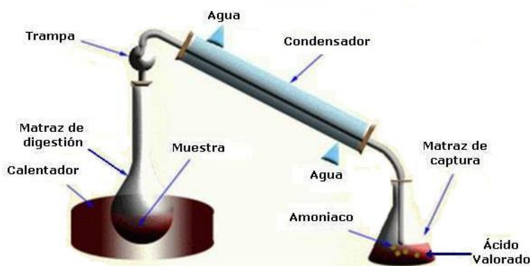
Figura 11. Sistema de desprendimiento de amoníaco 31.
