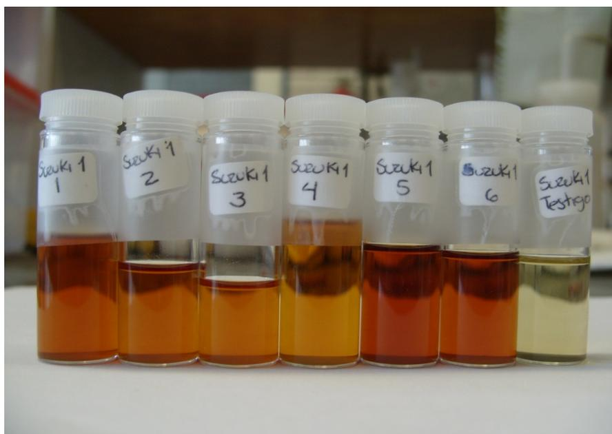
**Figura 4.2** Foto que ilustra las disoluciones obtenidas, después de purificar y filtrar cada uno de los tubos de catálisis utilizados en la **Sección 6.4** al concluir el tiempo de reacción. Nótese que el vial correspondiente al tubo testigo muestra una coloración verdosa y existe una ligera sedimentación de negro de paladio, ausente en los demás viales.
