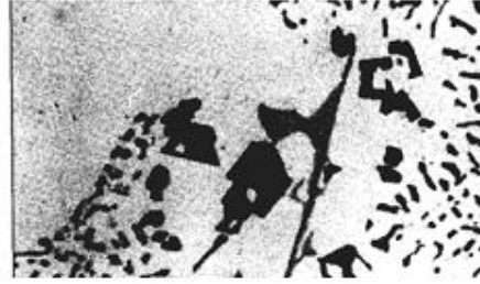
Clase 4: Estructura suficientemente modificada. La estructura laminar se ha fracturado completamente, pero pequeñas cantidades de fase acicular permanecen.
