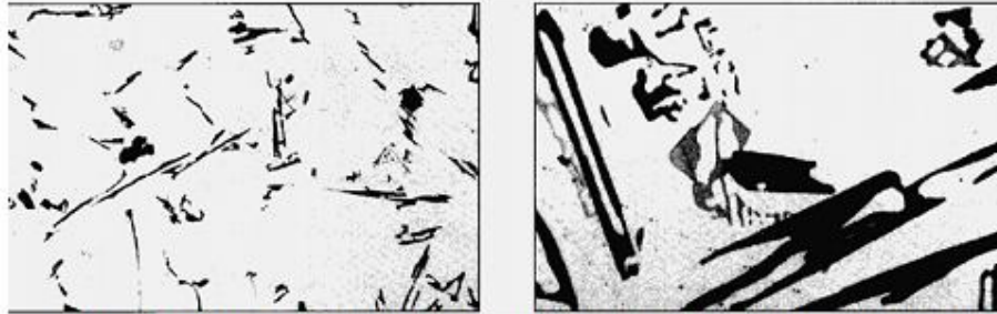
Clase 1: Estructura sin modificar. El silicio está presente como láminas largas, gruesas y de forma acicular.
