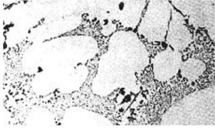
Clase 4: Estructura suficientemente modificada. La estructura laminar se ha fracturado completamente, pero pequeñas cantidades de fase acicular permanecen.
