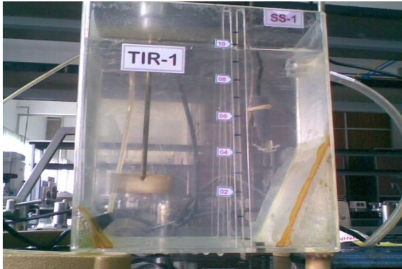
Fig. 3.2 Tanque de aireación piloto
