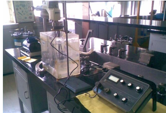
Fig. 3.3 Bomba de vacío, tanque de aireación, agitador y oxímetro
