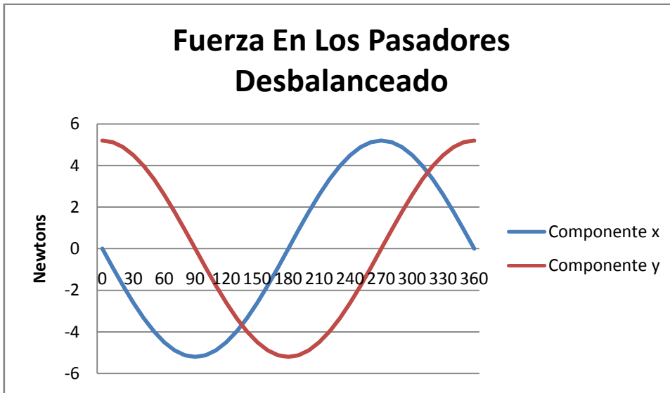
Gráfica 8.3 Fuerzas en el pasador del sistema sin balancear.
