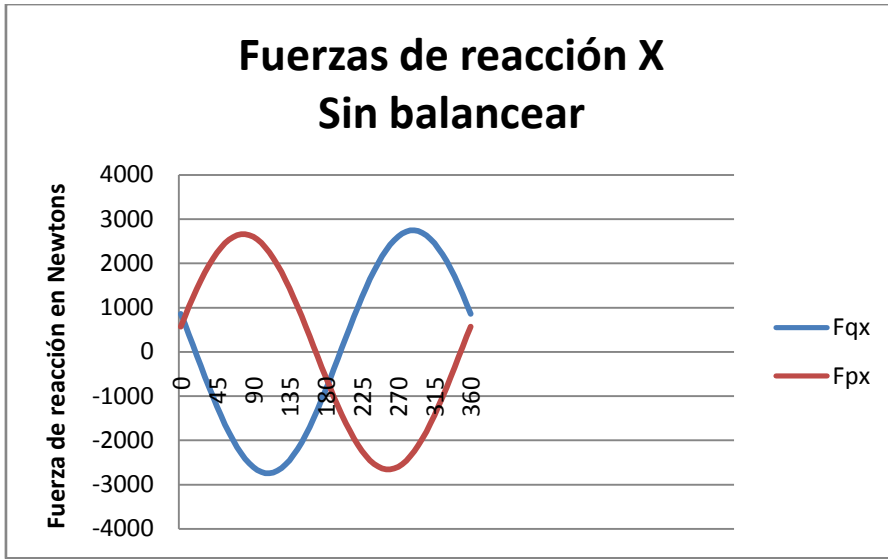
Gráfica 8.7 Fuerzas de reacción x en los rodamientos del sistema desbalanceado.
