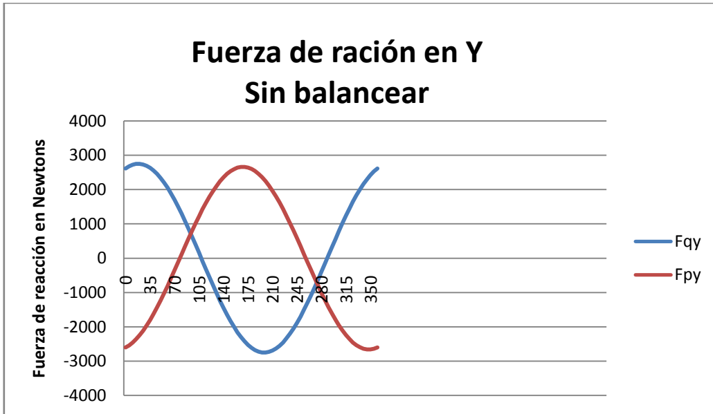
Gráfica 8.8 Fuerzas de reacción y en los rodamientos del sistema desbalanceado.
