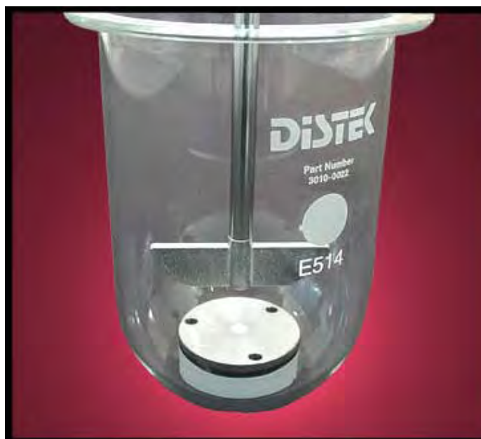
Figura No. 21 Sistema de disco estacionario para la determinación de Disolución Intrínseca. 71
