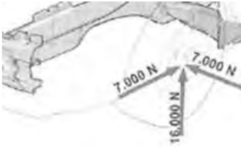
Figura 3.2 Cargas aplicadas en eje delantero
