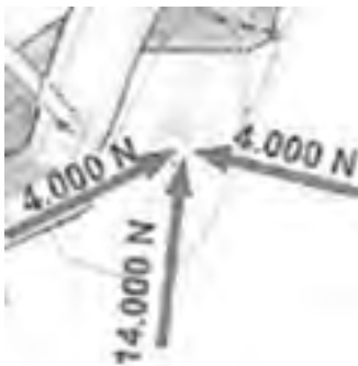
Figura 3.3 Cargas aplicadas en el eje trasero
