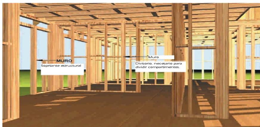
Figura 169. Muros soportantes y muros divisorios.
