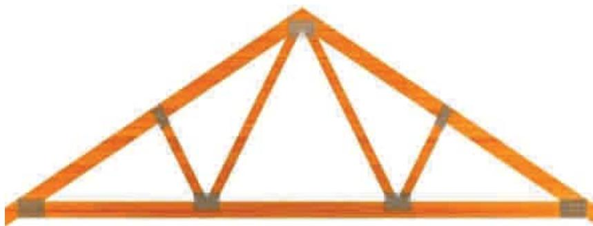
Figura 108. Estructura de techumbre armada con placas metálicas dentadas.
