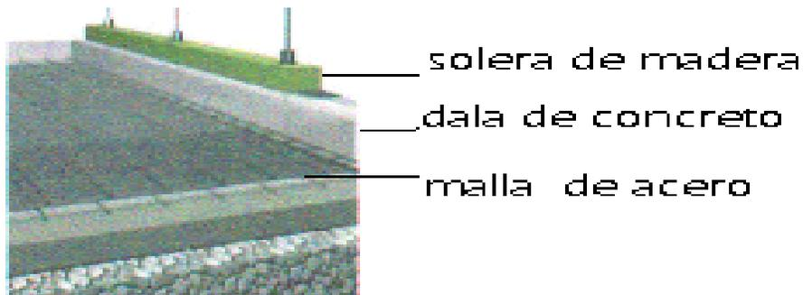
Figura 153. Piso de concreto con malla y cama de arena o grava.
