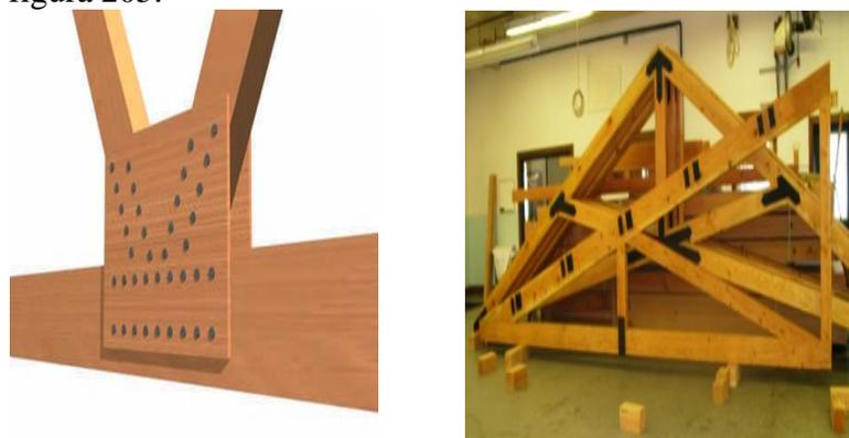
Figura 205. Cercha simple, placas de madera contra chapada en nudos y placas de acero.
