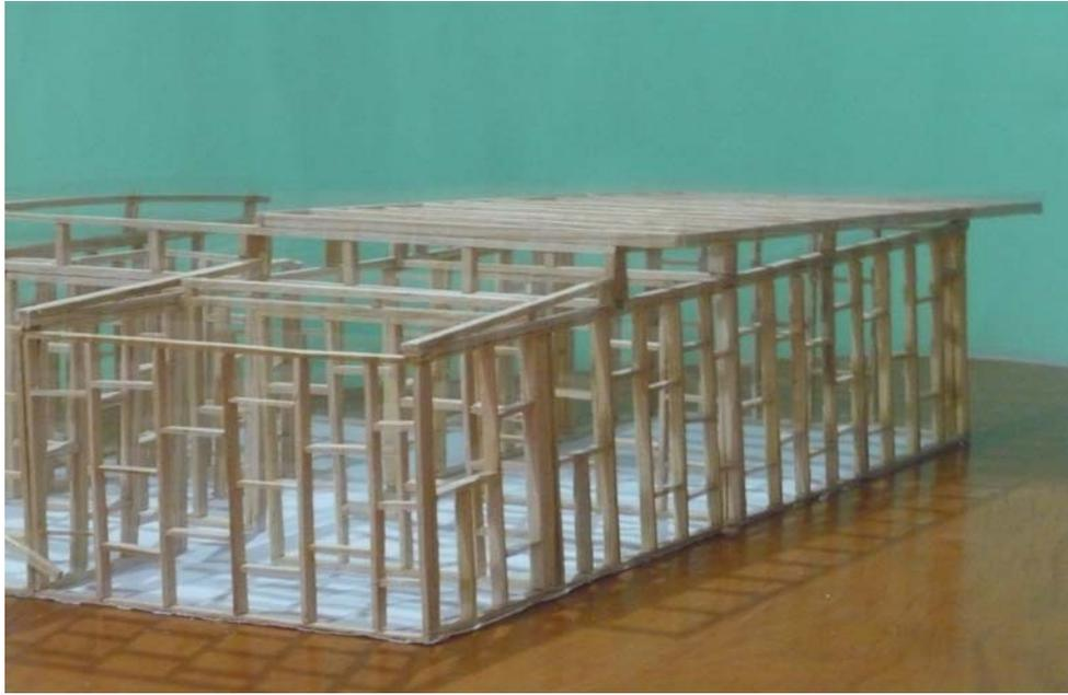
Figura 114. Vista lateral de los muros divisorios y de la estructura de la techumbre Trabajando como diafragma.
