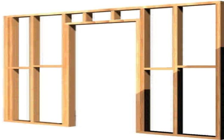
Figura 171. Entramado de un muro divisorio no estructural.
