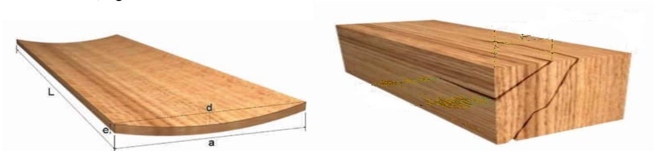
Figura140. Acanaladura y grietas en la madera.
