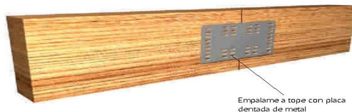
Figura 87. Empalme a tope mediante placas dentadas
