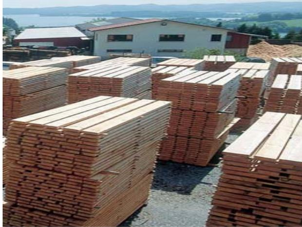
Figura 32. Secado de la madera al natural en pilas.
