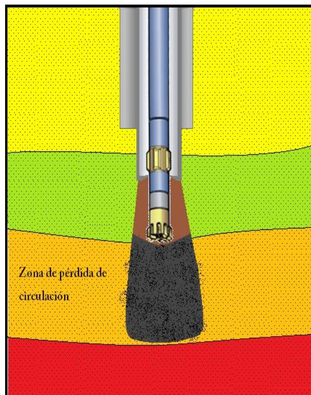
Figura 4.6 Tapón de cemento utilizado para sellar zonas con pérdida de circulación.
