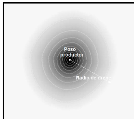
Figura 3.5 Incremento del radio de drenaje con la propagación del disturbio de presión antes de llegar a los límites del yacimiento.
