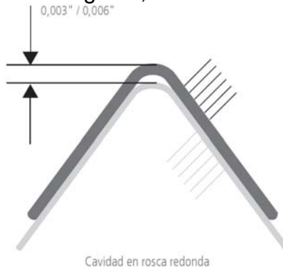
FIGURA 2-35. Acoplamiento de la Conexión 8HRR.
