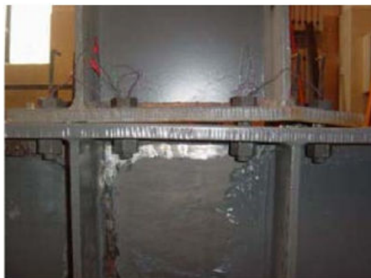
Fig.3.40 Espécimen fallado JD3, Shi et al (2006).
