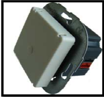
Figura 3.4 Sensor entálpico. Es un sensor combinado de temperatura y humedad para medir los factores de condición del aire, la temperatura, la humedad relativa, la humedad absoluta (llamada también contenido de agua), la temperatura del punto de rocío y la entalpía. Fuente: Sitio web RTS Automation
