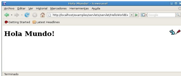
Imagen 4.13. Ejecución de servlet desde el puerto 80 a través de HTTPD.
