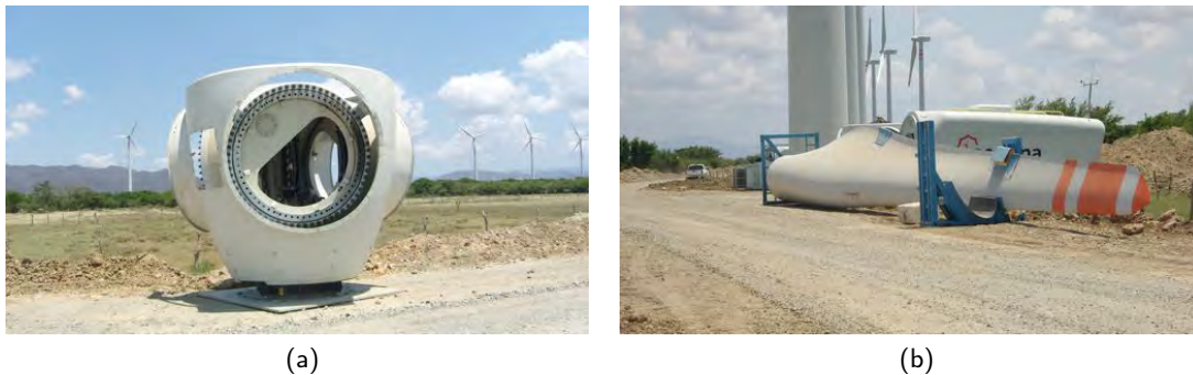
Figura 2.2.2: Cubo (a) y aspas (b) de un aerogenerador proyecto "Eurus", Juchitán, Oaxaca.
