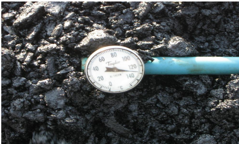
Figura. III.11.2.3. Verificación de la temperatura de la mezcla asfáltica en campo.
