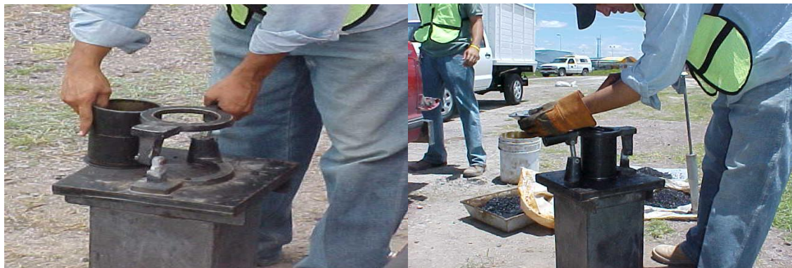
Figura. III.17.1.4. - Colocación de moldes sobre el pedestal
