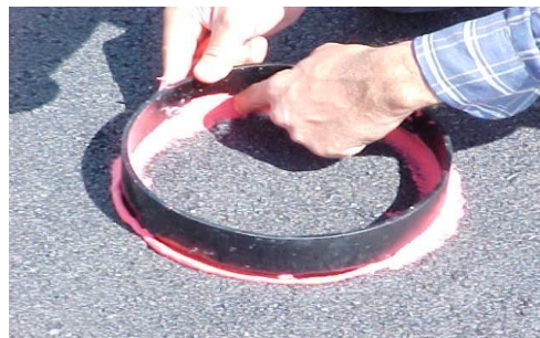
Figura. III.18.4.- Calafateado en ambas paredes del aro
