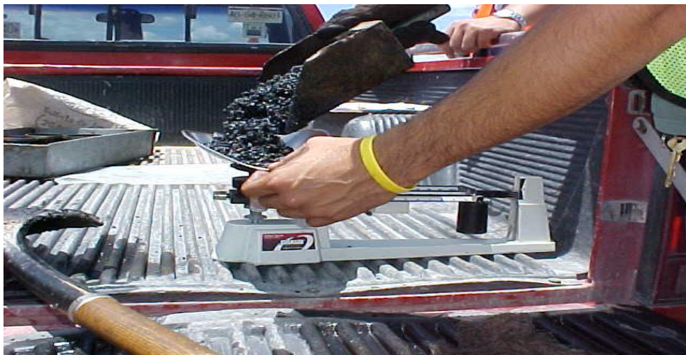
Figura. III.17.1.2. - Material asfáltico pesado con Balanza de precisión
