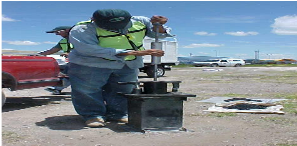
Figura. III.17.1.5. - Compactación de mezcla asfáltica con pison Marshall
