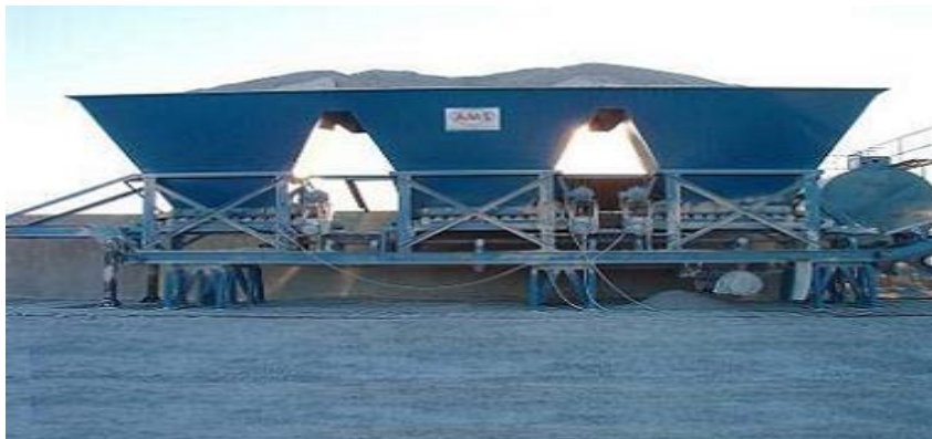
Figura. III.10.1.1.1 Tolvas para recepción de agregados.
