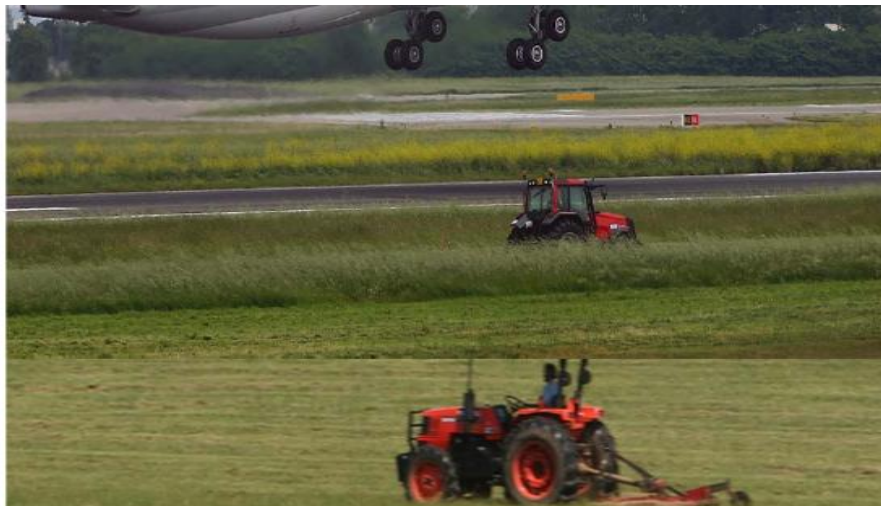
Figura. III.8.2.1 Restricción de objetos móviles durante los despegues y aterrizajes.
