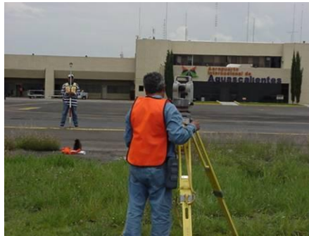
Figura II.2.1 .Brigada de topografía realizando trazo con equipo electrónico.
