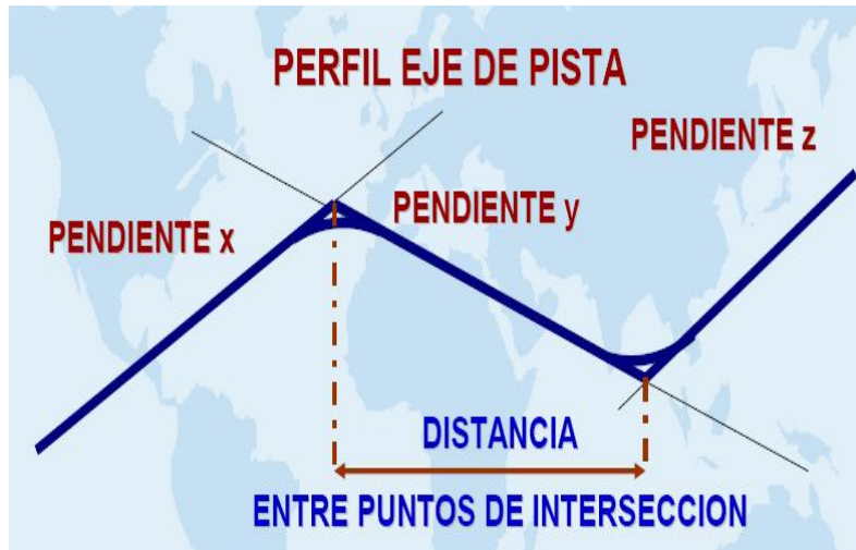
Figura. III.3.3 Cambios de pendiente longitudinal.
