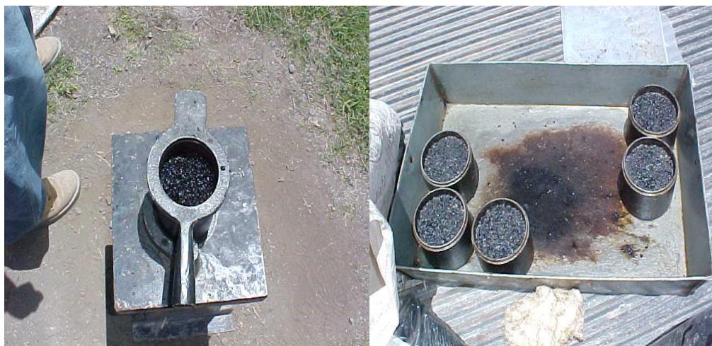
Figura. III.17.1.6. -Pastillas Marshall ya compactadas listas para llevarlas al laboratorio
