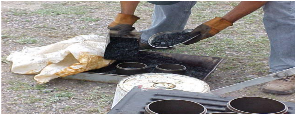
Figura. III.17.1.3. - Se vierte el material asfáltico sobre los moldes
