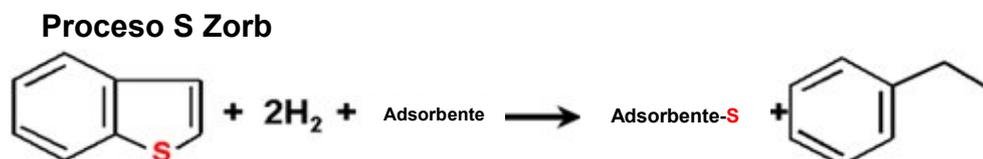
Figura 1.10. Reacción de adsorción proceso S Zorb.
