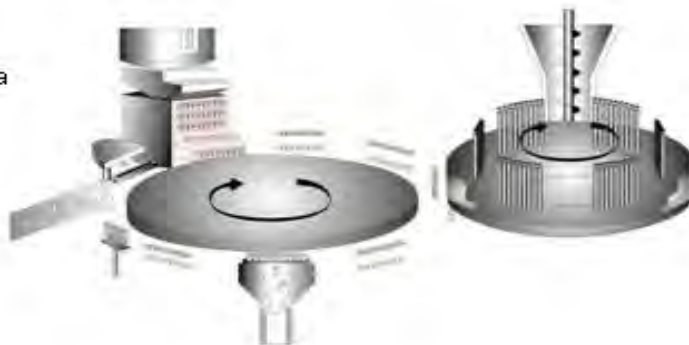
Figura 5. Diagramas de funcionamiento del equipo de dosificado de cápsulas de gelatina dura. http://www.capsulatech.com.ar/1-capsule-filling.html
