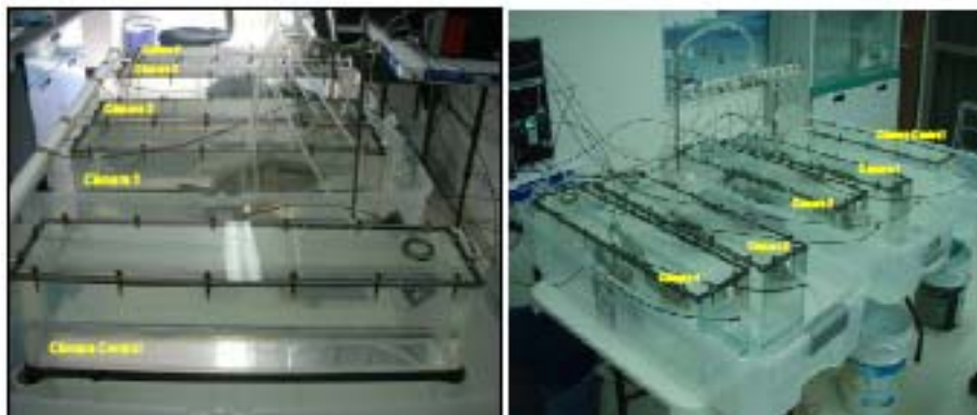
Figura 7.- Cámaras respirométricas utilizadas para medir el consumo oxígeno del mero rojo, Epinephelus morio
