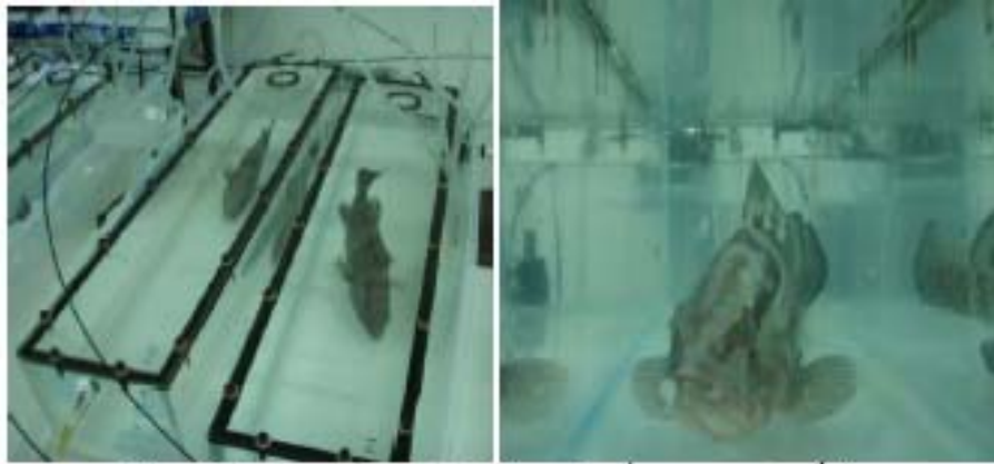
Figura 7.- Cámaras respirométricas utilizadas para medir el consumo oxígeno del mero rojo, Epinephelus morio .
