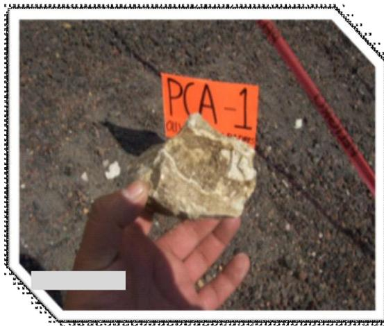
Material existente en el lugar donde se realizó el primer pozo, observándose el carbonato de calcio en capas delgadas.
