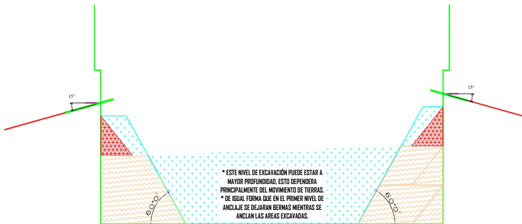
**SEGUNDA ETAPA DE EXCAVACIÓN.** Este nivel de excavación puede estar a mayor profundidad, esto dependerá principalmente del movimiento de tierras. De igual forma que en el primer nivel de anclaje se dejarán bermas mientras se anclan las áreas excavadas.
