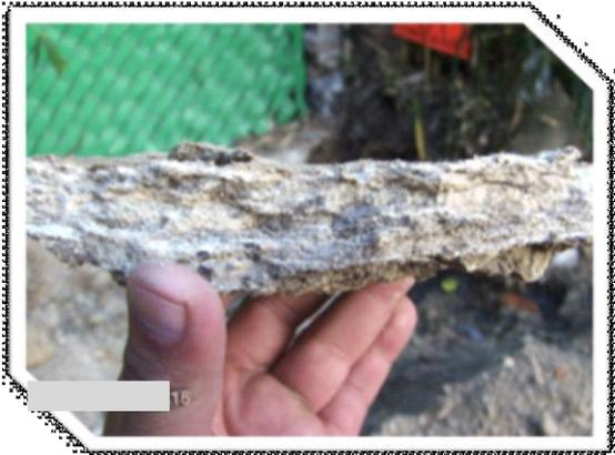
Carbonato de calcio obtenido de la excavación, la capa tiene un espesor aproximado de 15 cm.
