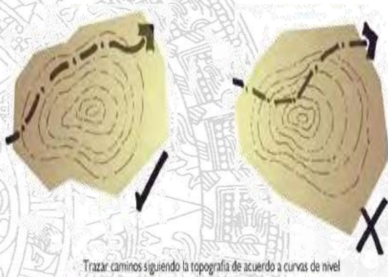
Foto 38 Trazo de vialidades siguiendo las curvas de nivel, para adecuarse al paisaje y evitar cortes o rellenos. Fascículo 9, turismo alternativo, SECTUR, México D: F., pp. 33
