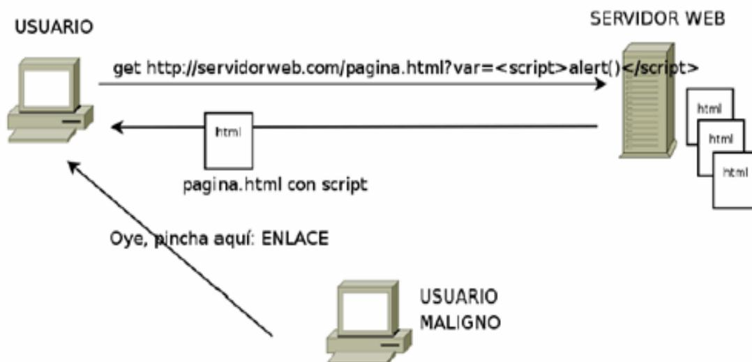
Figura 2.1 Funcionamiento de XSS
