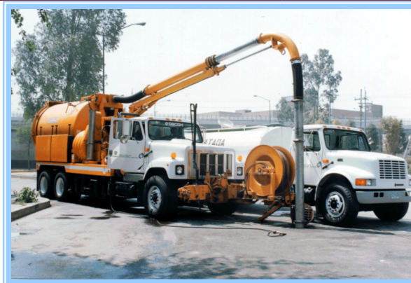
Foto No. 4 Muestra el Desazolve de redes de drenaje.
