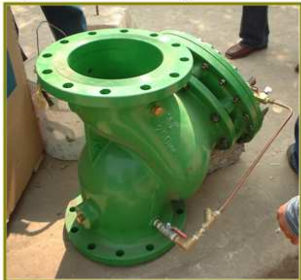
a) Vista exterior de la VRP
