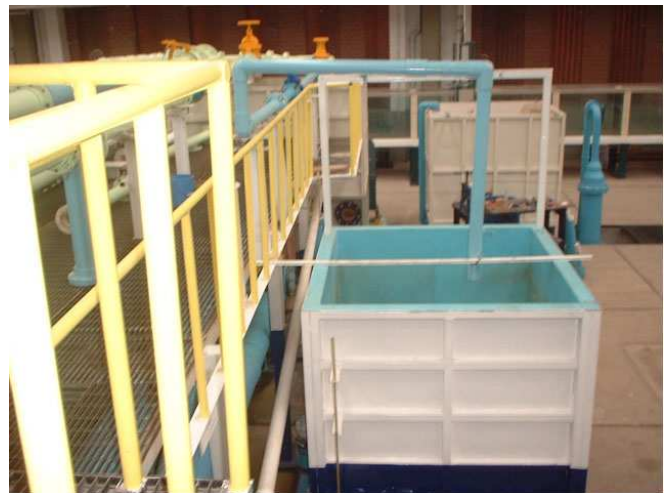
b) Equipo de laboratorio que se ocupa para realizar la verificación de micromedidores.
