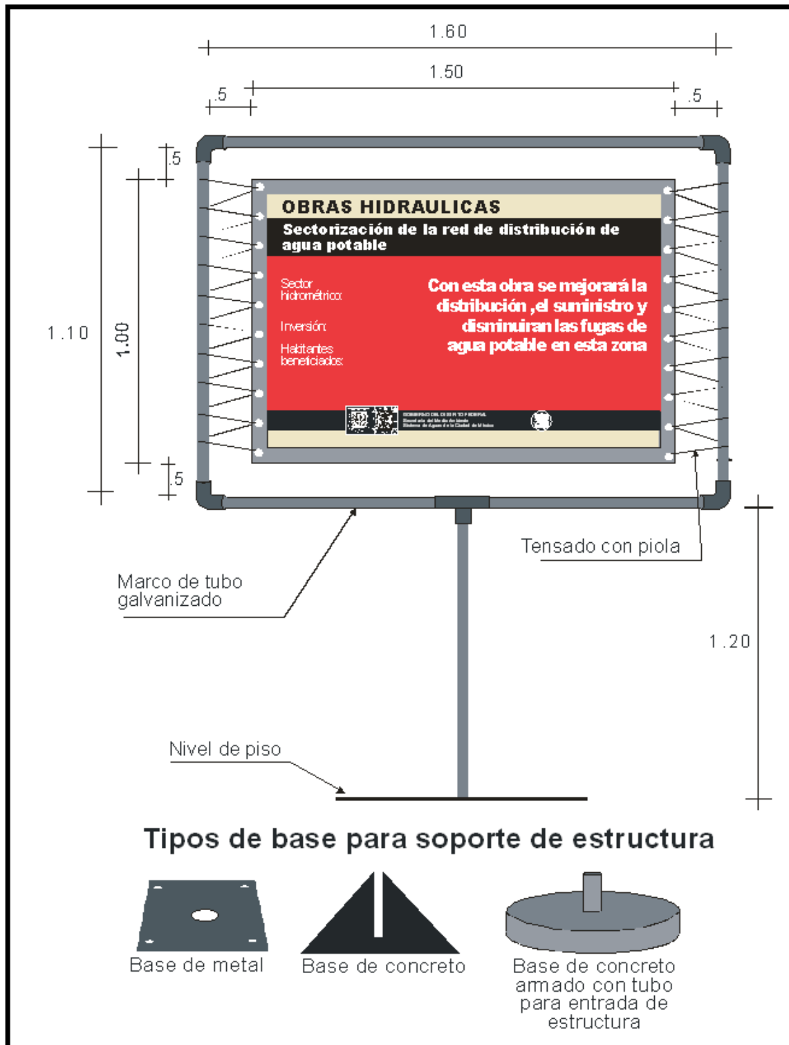
Figura 65.0.- Cartel de difusión de los trabajos de sectorización.
