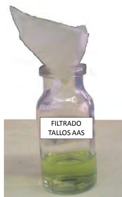
Fig. 4.13 Filtrado del líquido de extracción
