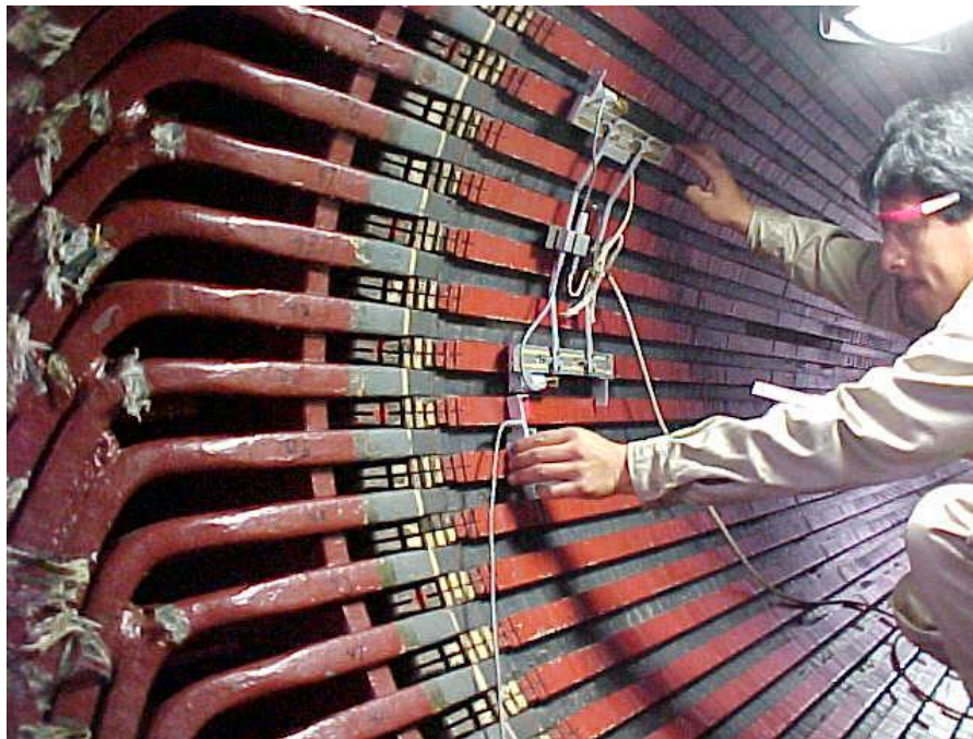
Fig 3.2.-.Realización de prueba de "ELCID" para determinar el estado del laminado antes del reembobinado
