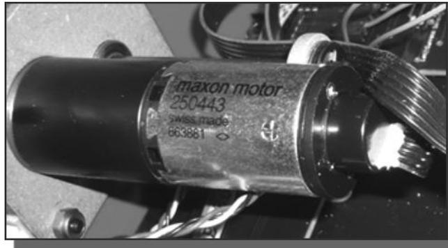
Fig. 5.4 Motor con engranaje y encoder
