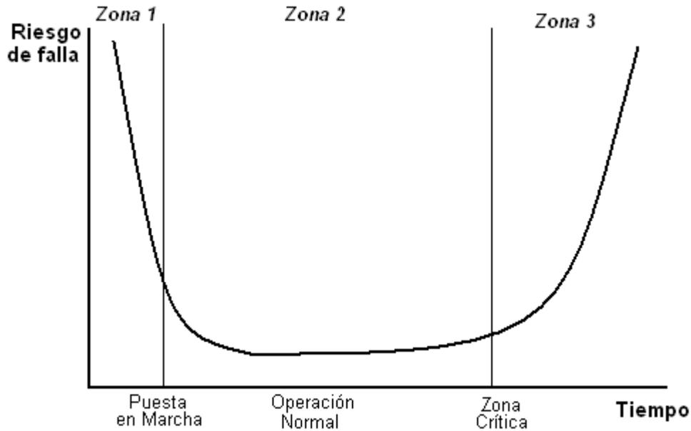
**Fig. 37 Curva de falla de un equipo**
