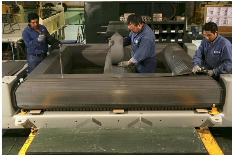
**Fig. 17 Núcleo de transformador de potencia.**
