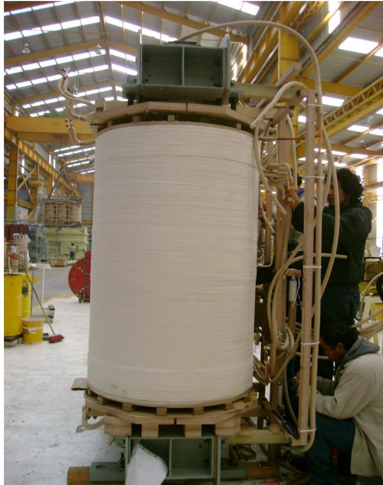
**Fig. 20 Devanado de un transformador de potencia**
