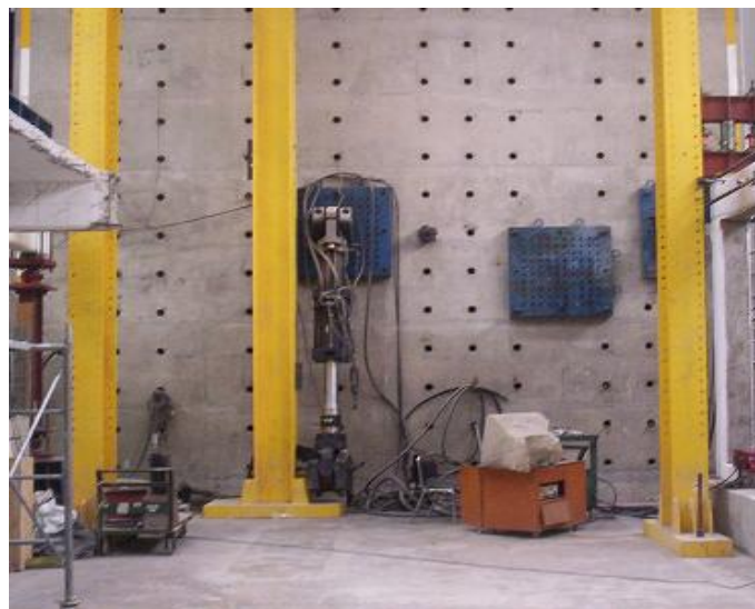
Figura V.2.1.- Losa de reacción, muro de reacción y columna amarilla dentro del LEG-CENAPRED
