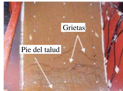
(d) Generación de grietas cerca del pie del talud
