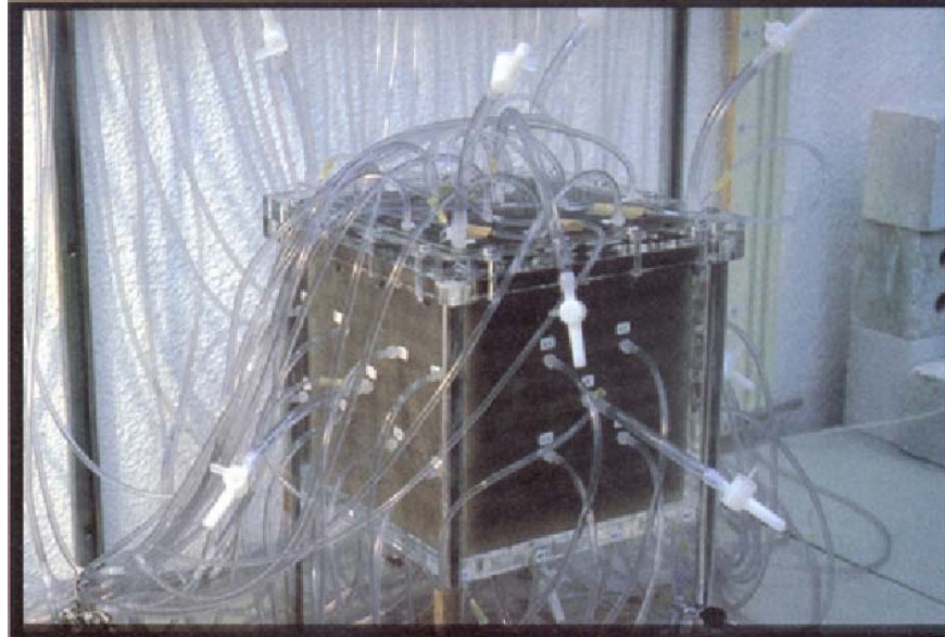
Figura 2.1 Permeámetro prototipo para determinar un tensor de permeabilidad en el laboratorio (Renard, Genty & Stauffer, 2001)
