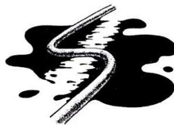
***Figura c. Evitar que el conductor este expuesto a sustancias.***
