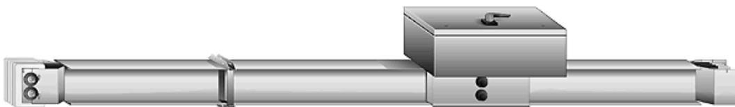
Los electroductos deben instalarse en forma visible y en lugares despejados, se permite la instalación de electroducto detrás de paneles si están accesibles y se cumple con las siguientes condiciones.
