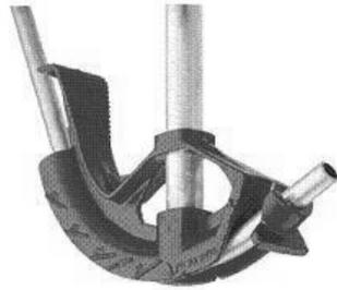
Las siguientes figuras nos muestran un ejemplo del doblado de tubo conduit a 90° y 45°:
