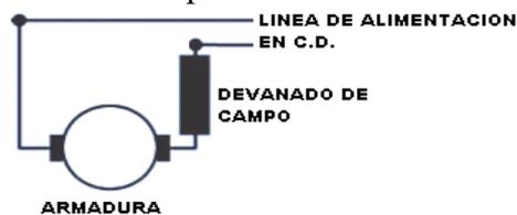
Figura 1. Representación de la conexión de un motor de C.D. en conexión serie.
