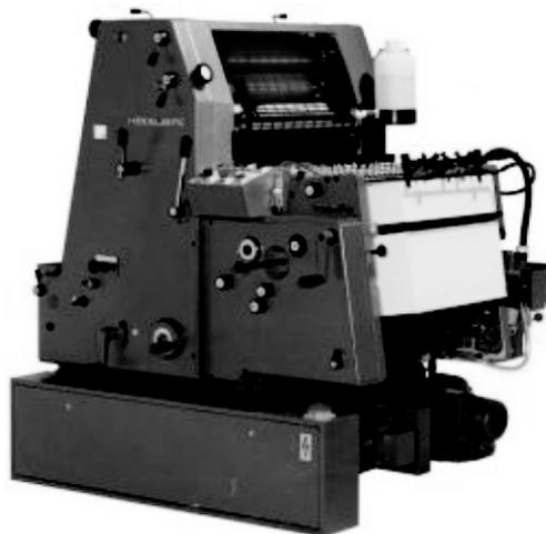
Máquina de Offse HEIDELBERG GTO 60000 con una Impresión directa a 600 puntos por pulgada o a 2.400 puntos por pulgada.
