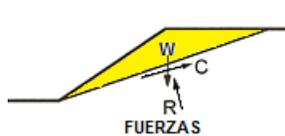
$$FS = \frac{\Sigma \text{ de fuerzas resistentes a lo largo del plano de deslizamiento}}{\Sigma \text{ de fuerzas que movilizan la falla}}$$
