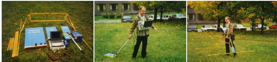
Figura 3.12 Equipo de geo-radar o GPR.
