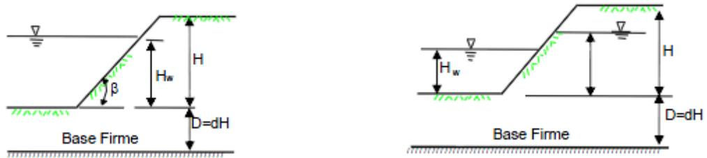
Figura 5.10 Factor de reducción por sumergencia ( $\mu_w$ ) e infiltración ( $\mu'_w$ ).
