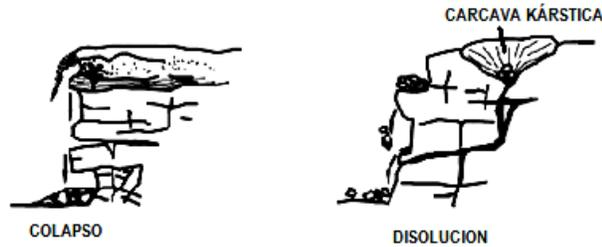
Figura 2.7 Esquema de procesos de colapso y disolución.
