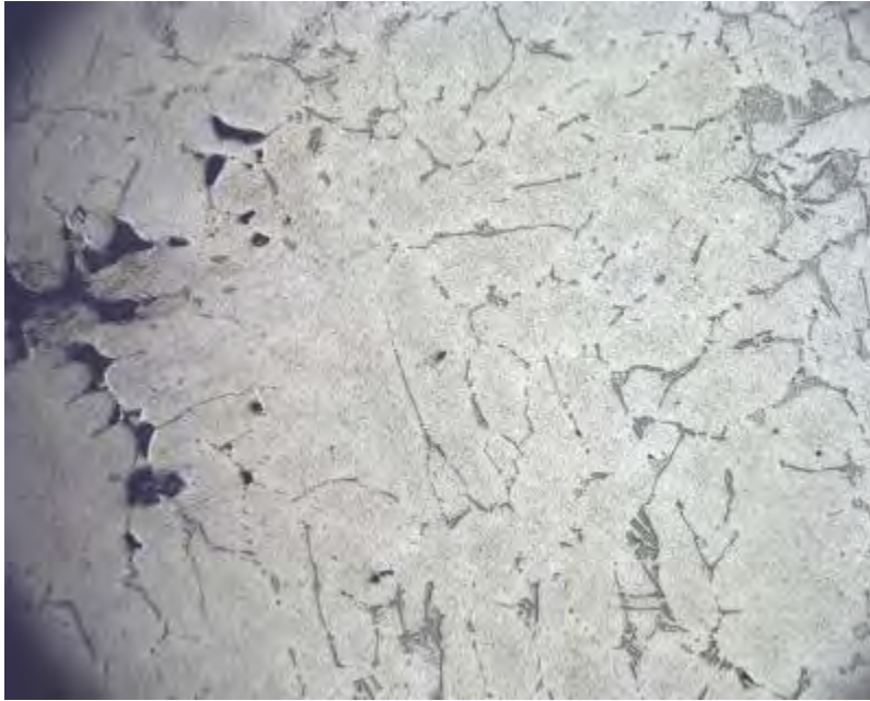
Imagen 6.2- Intermetálicos, poros en el aluminio recuperado, Muestra 11-CF-A-03-09, Zona 1, 200x.
