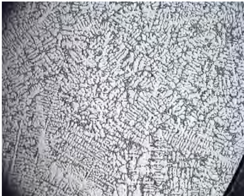
Imagen 4.0- Intermetálicos, poros en el aluminio recuperado, Muestra 07-CF-A-25-03, Zona 1, 50x.
