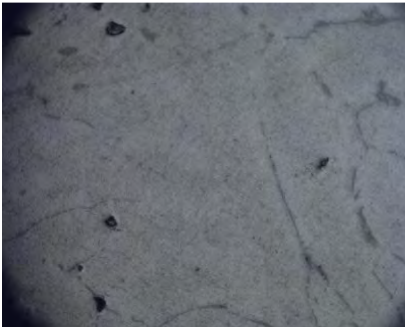
Imagen 6.3- Intermetálicos, poros en el aluminio recuperado, Muestra 11-CF-A-03-09, Zona 1, 500x.
