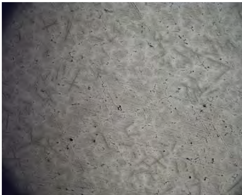
Imagen 3.1- Intermetalicos, poros en el aluminio recuperado, Muestra 04-CF-A-11-02, Zona 1, 100x.
