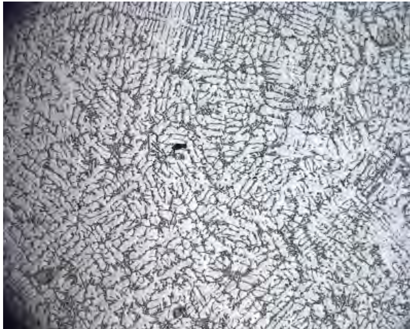
Imagen 7.0- Intermetálicos, poros en el aluminio recuperado, Muestra 12-CF-A-03-09, Zona 1, 50x.
