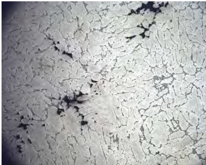
Imagen 6.1- Intermetálicos, poros en el aluminio recuperado, Muestra 11-CF-A-03-09, Zona 1, 100x.
