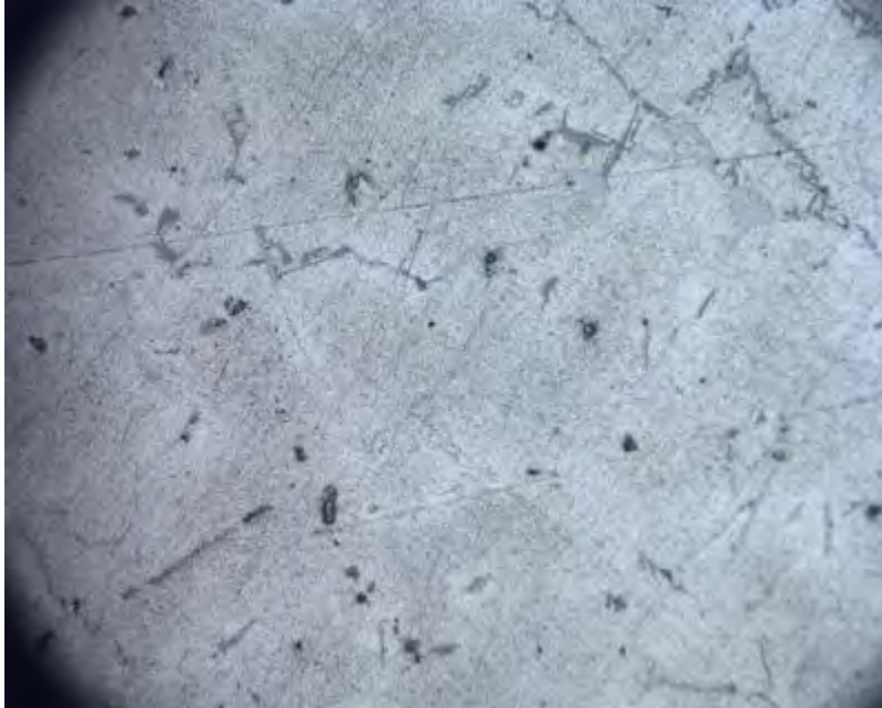
Imagen 2.2- Intermetálicos en el aluminio recuperado, Muestra 02-SF-B-23-01, Zona 1, 500x.
