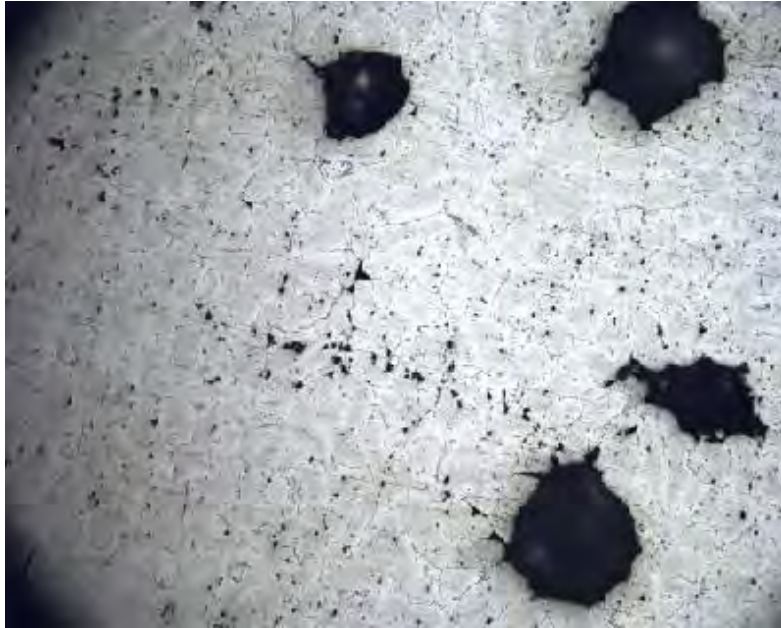
Imagen 1.1- Escorias, rechupes, poros en el aluminio recuperado, Muestra 02-SF-A-23-01, Zona 2, 100x
