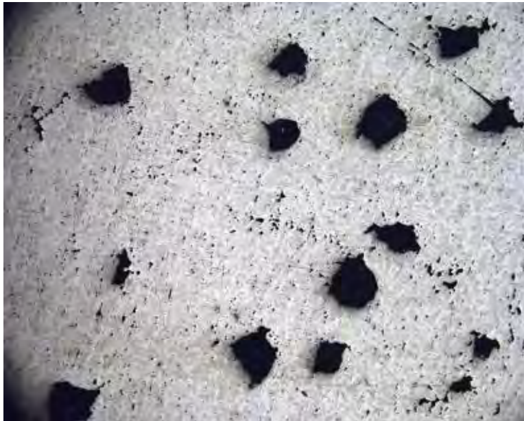
Imagen 1.0- Escorias, rechupes, poros en aluminio recuperado, las grandes y pequeñas zonas oscuras, Muestra 02-SF-A-23-01, Zona 1, 50x.
