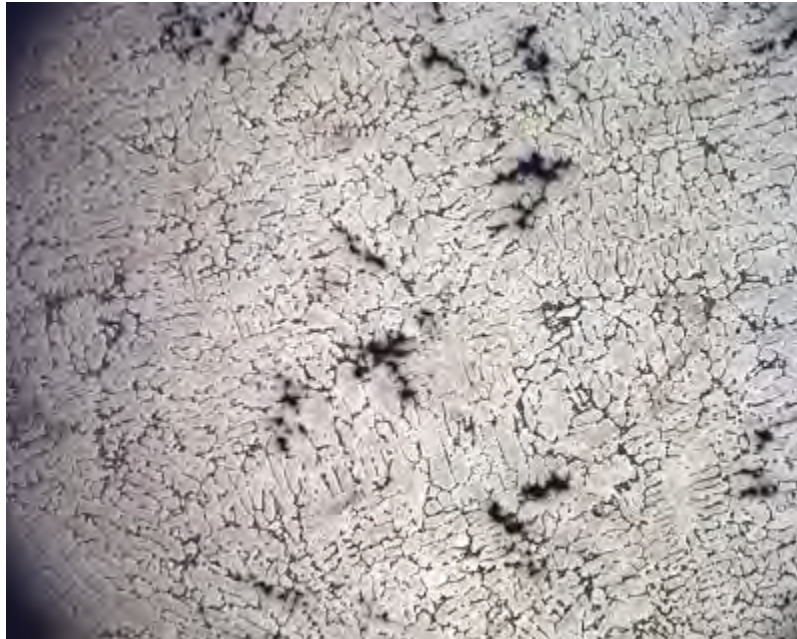
Imagen 6.0- Intermetálicos, rechupes, poros en el aluminio recuperado, Muestra 11-CF-A-03-09, Zona 1, 50x.
