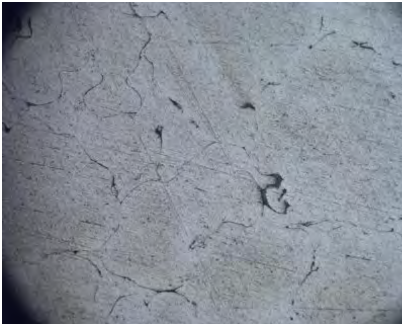
Imagen 3.3- Intermetálicos en el aluminio recuperado, Muestra 04-CF-A-11-02, Zona 2, 500x.
