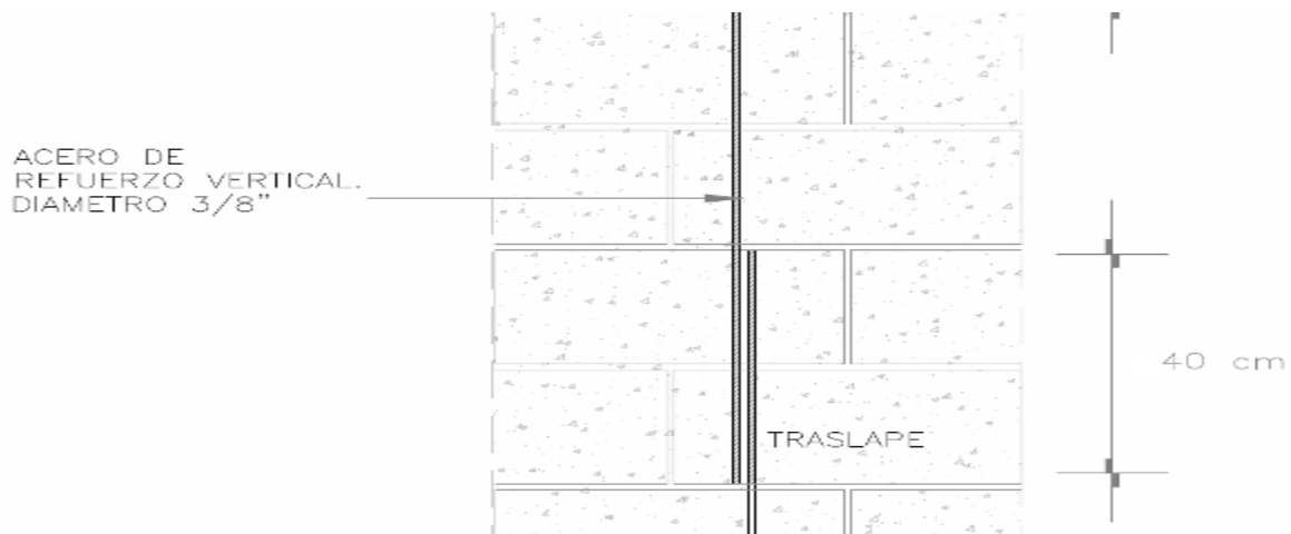
Figura IV.12 Traslape de acero
