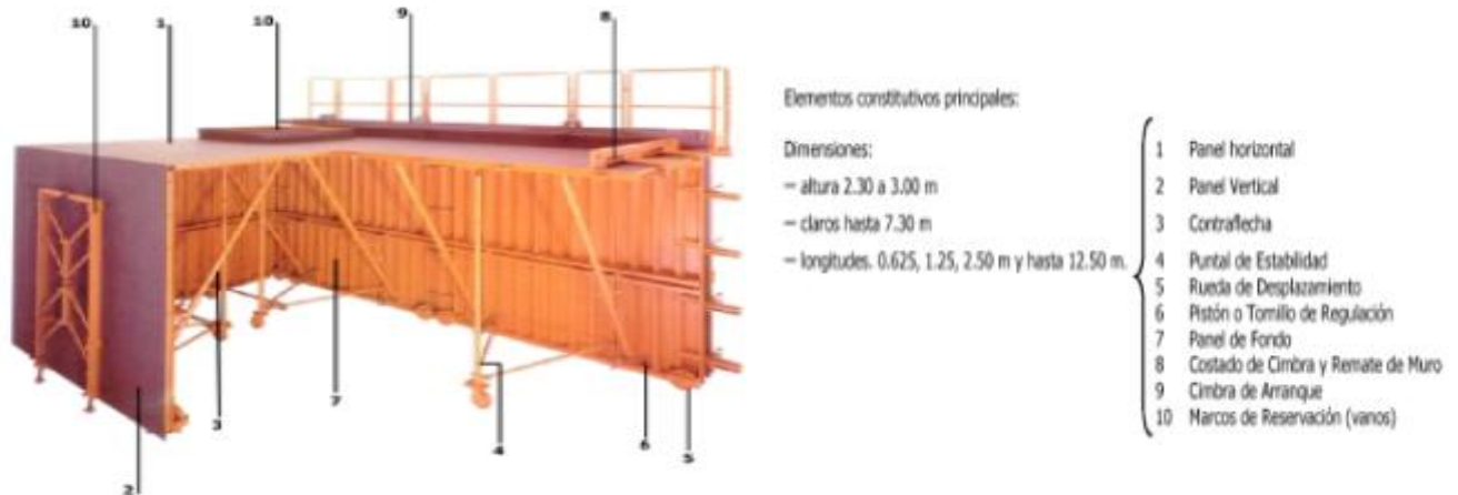
IV.22 Ejemplo de Cimbra Túnel
