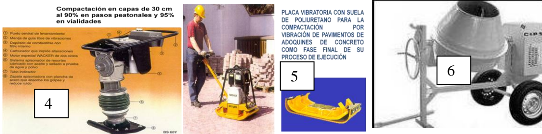
Figura V.16 Ejemplo de Compactadora de Impacto (4), Placa vibratoria (5) y Revolvedora (6)
