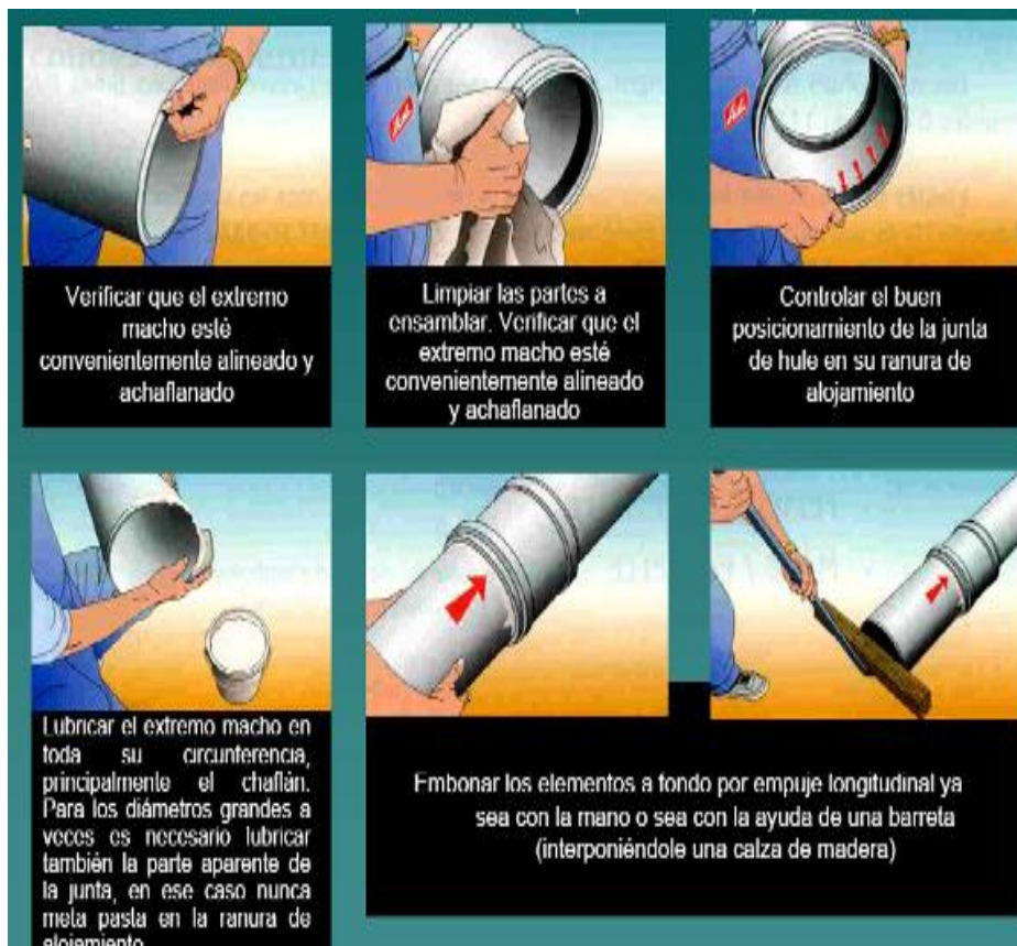
Figura IV.48 Secuencia de Ensamblaje de Tubería PVC
