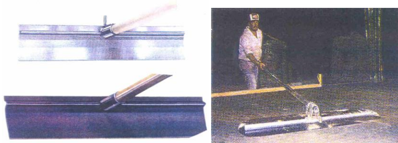
Figura V.24 Ejemplo de “aviones” para extendido de concreto
