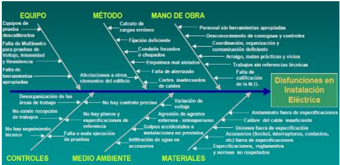
Figura IV.63 Disfunciones más comunes de las instalaciones eléctricas
