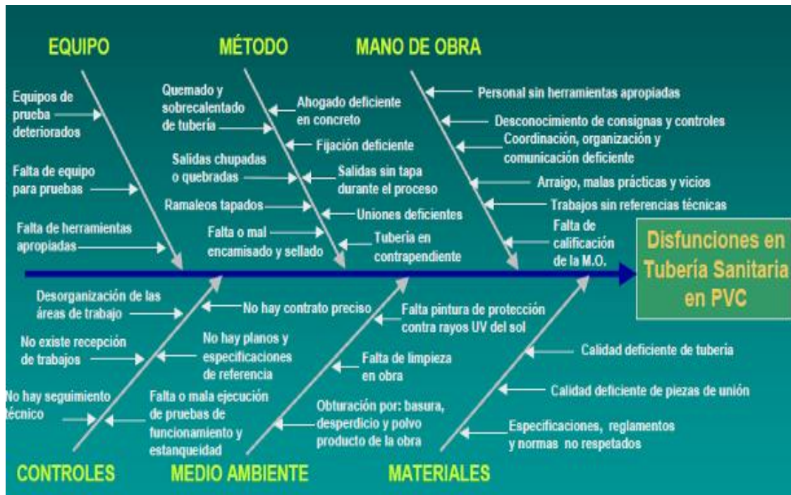
Figura IV.46 Disfunciones más comunes en instalaciones Sanitarias
