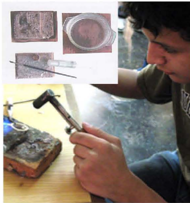
24. Superficie ignífuga y líquidos de limpieza
