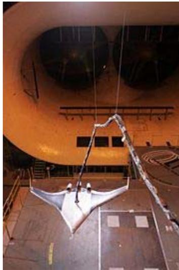
*Figura 1.3 Modelo a escala de un avión en un túnel de viento.*
