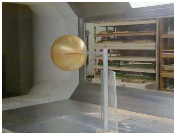
Figura 3.24 Esfera de turbulencia.
