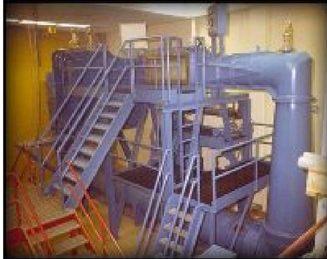
*Figura 1.7 Ejemplo de un túnel de agua.*
