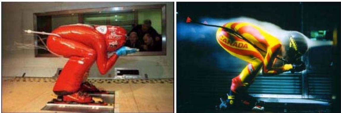
Figura 2.4 Túnel de Viento de la Universidad de Glasgow.
